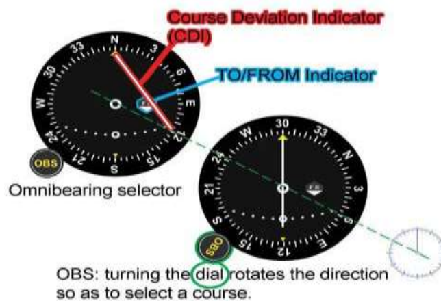
VOR indicator met OBS:Omni Bearing Selector.
